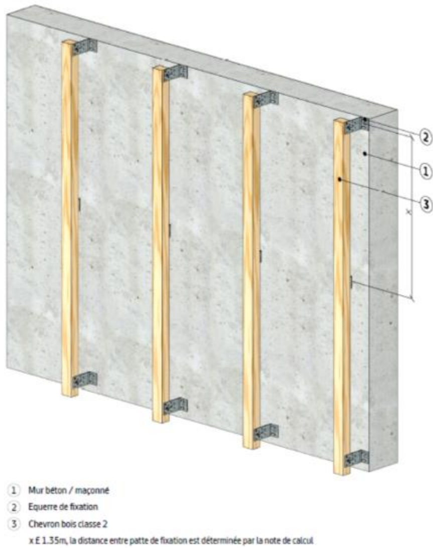
Figure 2 - Schéma de principe de la mise en œuvre des ossatures bois
